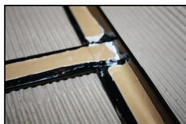
**NL:** Vervolgens neemt u de frame (PO6) en neemt van de tape verstevig (bescherming) uit, wees voorzichtig, doe het langzaam. Zet dan de polycarbonaat plaat naar beneden in het frame. Gelieve juiste plaatsing alvorens de tape bescherming film af. Verzekeren dat de gaten zijn over elkaar. Een siliconen lijn kan in worden gezet om extra bescherming te verzekeren.
